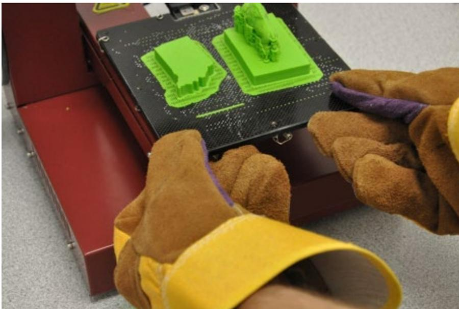
Figura 1: Remoción de una placa perforada
