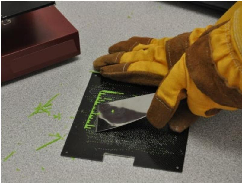
*Figura 2: Retirando filamento de una placa perforada*
