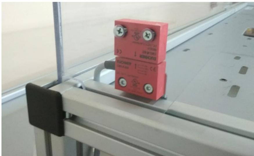
5. Retire el protector de seguridad y ajuste completamente el cabezal de lectura magnético inferior al soporte.
