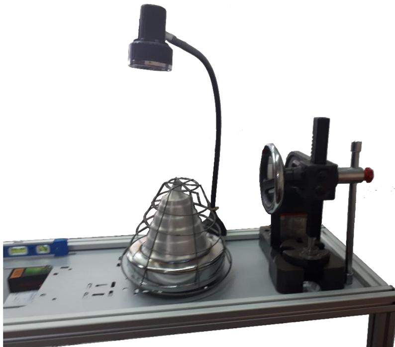
La prensa (36-0900-0012) se fija a la superficie de trabajo en la posición y orientación mostradas aquí y utilizando los tornillos hexagonales (2), las tuercas hexagonales (2), las arandelas planas (4) y las
