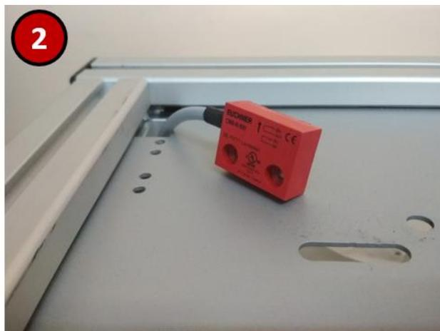
3. Asegure el cabezal de lectura a la parte superior de la superficie de trabajo utilizando el soporte y los tornillos que se incluyen. No apriete completamente el cabezal al soporte todavía, ya que puede ser necesario ajustar su altura.
