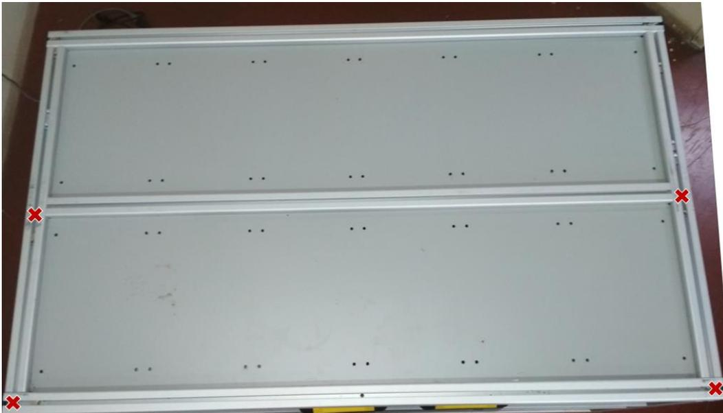
**ⓘ Nota:** la colocación sobre los puntos antes indicados permite la incorporación de una segunda superficie de trabajo en la parte superior del banco móvil.
